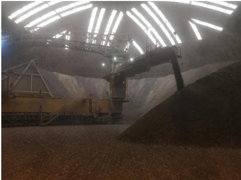
Ilustración 6. Recuperador y apilador unidos por columna central
